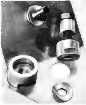
In 1½ Min. werden mit dem **Rekordlocher** einwandfreie Löcher in Metall und alle Materialien gestanzt. Leichte Handhabung - nur mit gewöhnlichem Schraubenschlüssel. Standardgrößen von 10-65 mm Ø, von DM 9,75 bis DM 52.—
